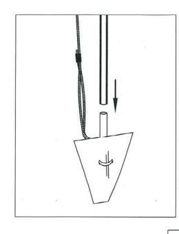
CABLE IS ATTACHED AND CRIMPED. DRIVE ROD IS HALF INCH BLACK IRON PIPE - 4 FEET LONG
