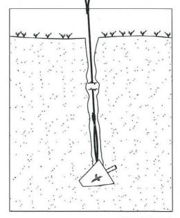
ANCHOR MUST BE PULLED UP INTO PLANED / LOCKED POSITION
